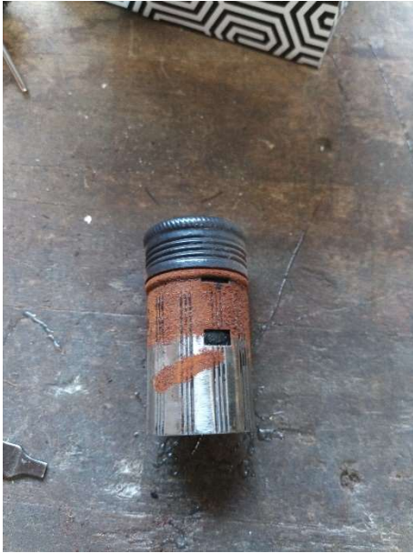
Bild 4. „Linsenträger“ aus vernickeltem Stahlrohr, Schraubdeckel und Linse. Die Löcher im Rohrkörper sind von Innen mit schwarzem Klebeband kaschiert.
