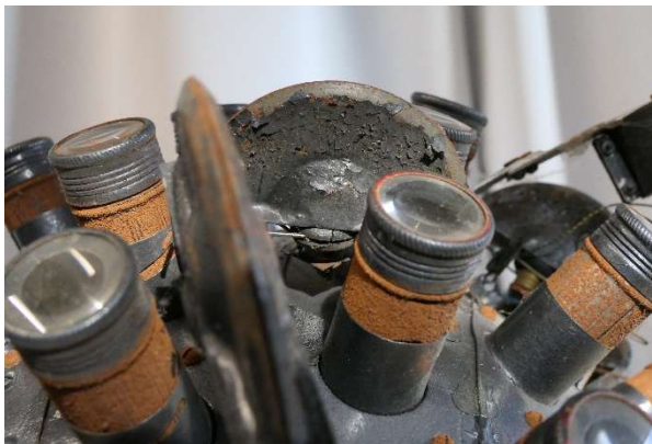
Bild 2. Projektorlinsen in den modifizierten Schraubverschlüssen. Die vernickelten Stahlrohre sind stark korrodiert.
